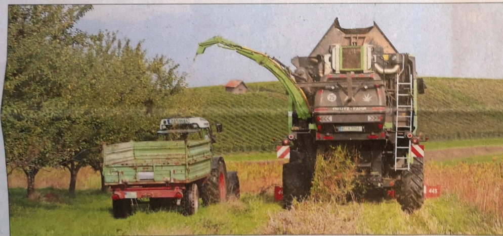
Aus eins mach drei: Simon Glaser nimmt mit seinem Hänger die Blütenblätter auf, die Hanfsamen landen in einem Tank der Dreschmaschine, die Stängel erstmal am Boden.
